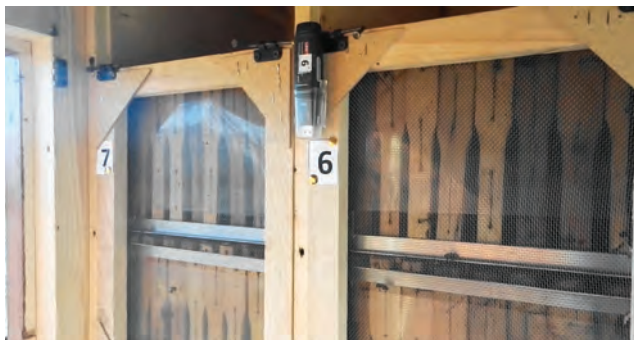
Рис. 4. Автономные регистраторы (UT330В) установленные в семьях Группы 1
